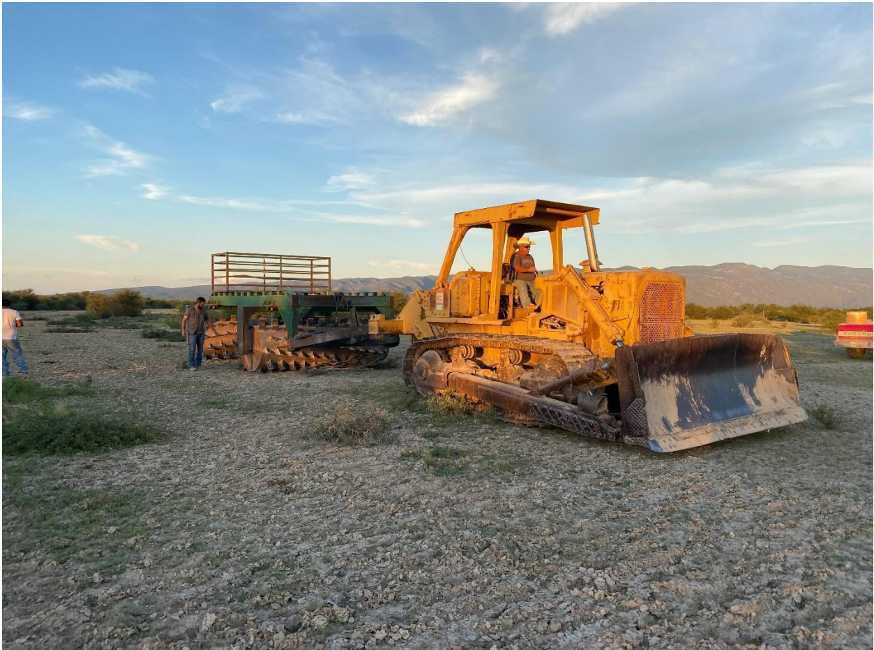
Figura 1. Rodillo aireador en operación en rancho La Ciénega, Candela, Coahuila
