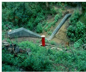
Aforador tipo V de cresta angosta
